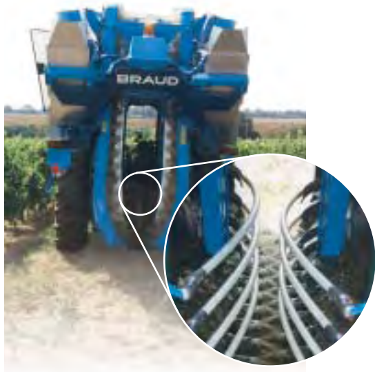
Barras "vibratorias" de ERTALON 66SA en una cosechadora
